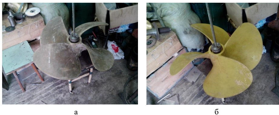
Рис. 2. Общий вид сравниваемых гребных винтов: а – оригинальный винт; б – винт-дублер (изготовлен в США)
