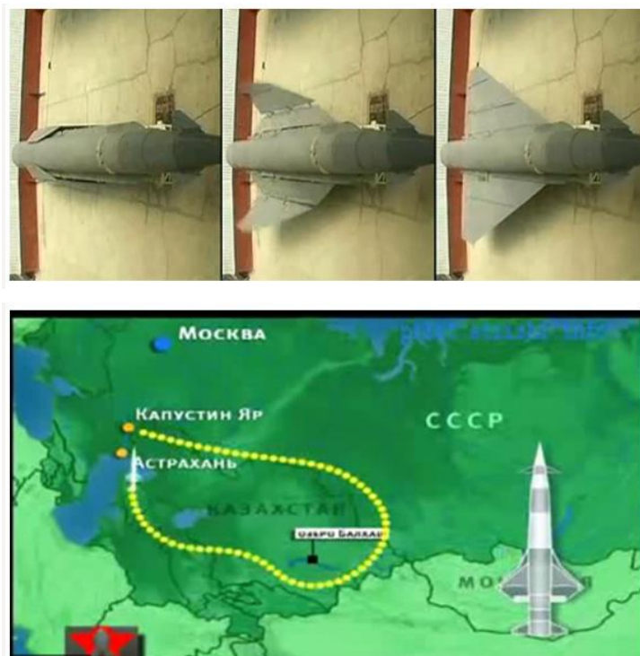
Рис. 2. Маршрут испытаний и особенности складных крыльев ракеты «Метеорит-А»
