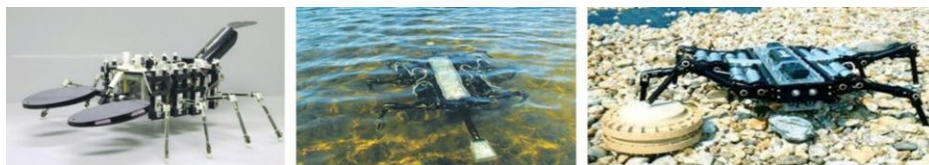
Рис. 1. Подводные шагающие роботы для разминирования: Benthic Autonomous Underwater Vehicle (слева), ARIEL (в центре), ARIEL-II (справа)
