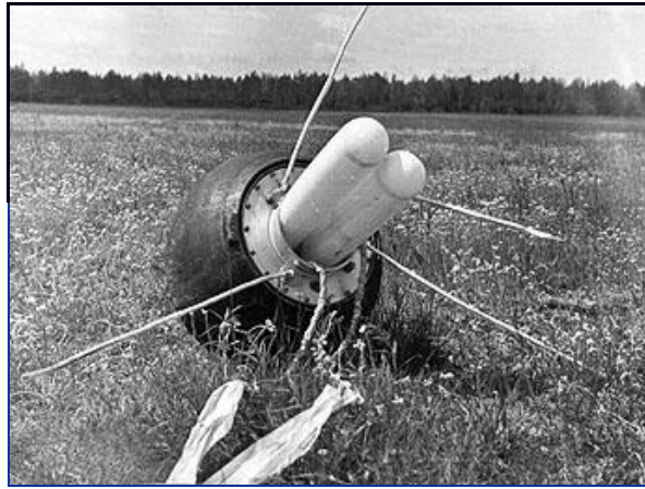
Рис. 5. Возвращаемый аппарат «Луны-16» доставлен на Землю
