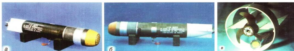
Рис. 2. Итальянская сверхмалая торпеда A200: а – вид спереди; б – вид сбоку; в – хвостовая часть
