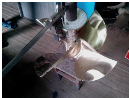
Рис. 1. Измерения геометрических характеристик гребного винта: а – схема замеров; б – механическая установка
