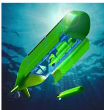
Рис. 5. Пуск торпеды с АНПА
