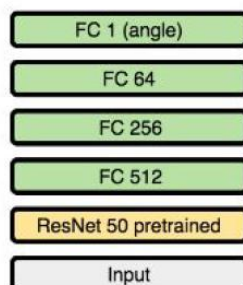
Рис. 2. Архитектура адаптированной CHC ResNet50 из [5]
