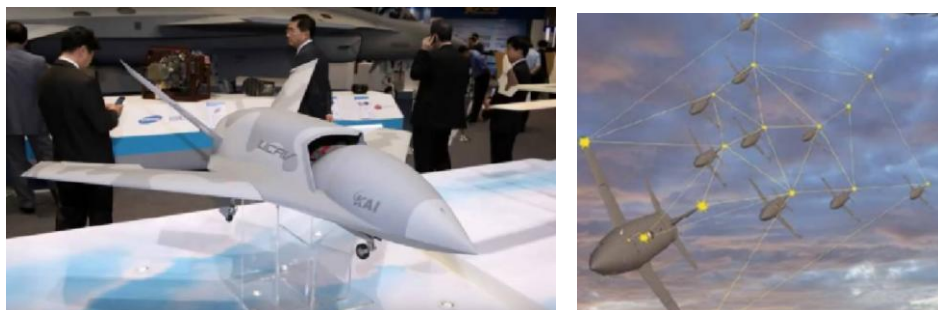
Рис. 1. Сверхзвуковой беспилотный летательный аппарат (БЛА) XQ-222 Valkyrie («Валькирия») и группа в полете
