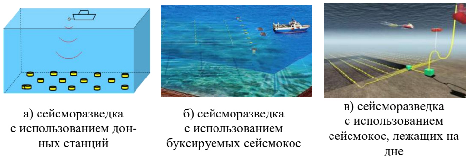
Рис. 1. Способы сейсморазведки, используемые в настоящее время
