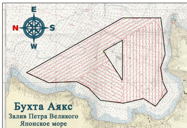
Рис. 1. Траектория покрытия акватории, сгенерированная алгоритмом
