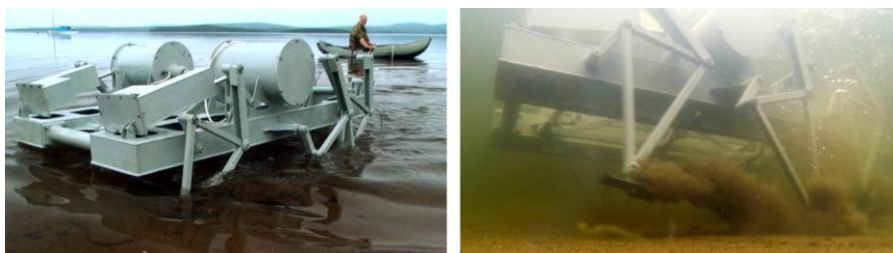
Рис. 4. Испытания шагающей платформы с цикловыми шагающими движителям
