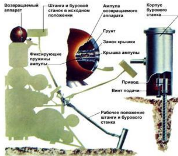
Рис. 4. Схема работы грунтозаборного устройства на поверхности Луны
