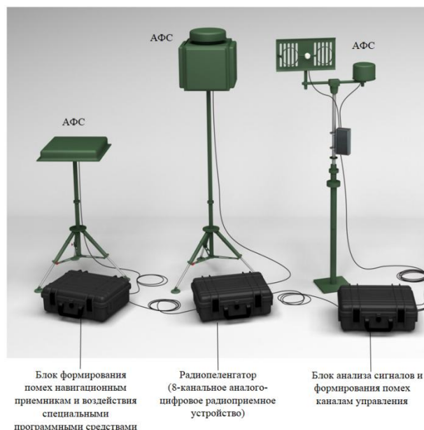
Рис. 4. Внешний вид комплекта радиотехнического оборудования поста РОЭМ и РЭП
